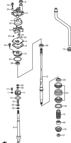
**F-5 PROPELLER SHAFT/PROPELLER (LA/XA)**
